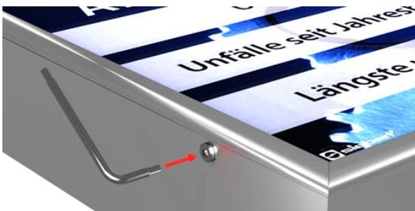
Bei Geräten für Aussenanwendung müssen die Steckleisten nach dem Einsetzen in den Gehäuserahmen mit den Torx Schrauben verschraubt werden. Verwenden Sie hierzu den mitgelieferten Schraubendreher.
